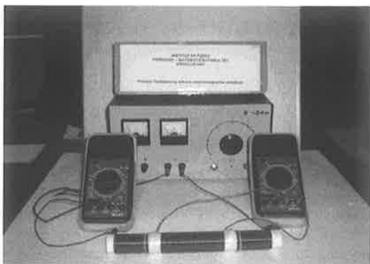
СЛИКА 13. Опис експеримента: А и V су амперметар и волтметар. Као струјни извор користи се извор наизменичне струје. Карактеристични параметри су: N_1 = 440 , N_2 = 250 , L_1 = 24.5 \text{ cm} , L_2 = 14.5 \text{ cm} , l_1 = l_2 = 5 \text{ cm} , R_1 = 15.5 \text{ mm} . Дебљина жице која је коришћена за намотаје је 0.5 \text{ mm} .
