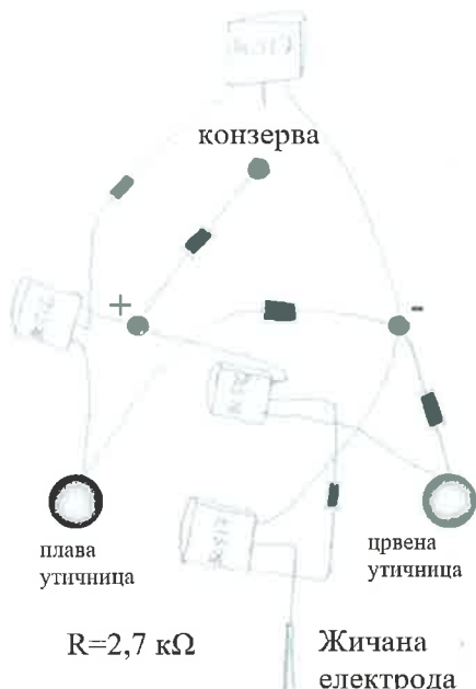
СЛИКА 7. Фотографија и блок схема повезивања електронике јонизационе коморе.
